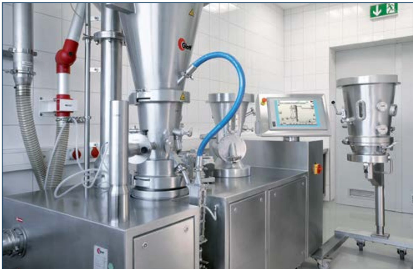
Рис. 4. Универсальная лабораторная установка типа ProCell Lab System для всех технологических процессов псевдооживления: грануляция, агломерация, покрытие, инкапсуляция – в непрерывном и серийном режимах
