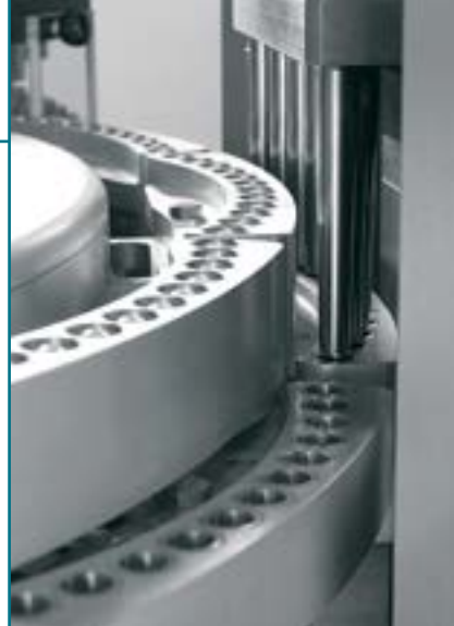
Рис. 3. Система 100 % гравиметрического контроля наполнения по массе капсулонаполнительной машины Adapta
