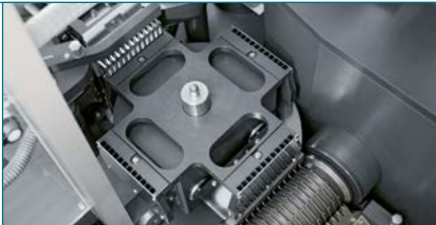
Рис. 3. Система 100 % гравиметрического контроля наполнения по массе капсулонаполнительной машины Adapta
