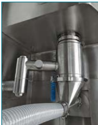
Рис. 1. Гранулятор для влажного гранулирования и влажное гранулирование в режиме онлайн
