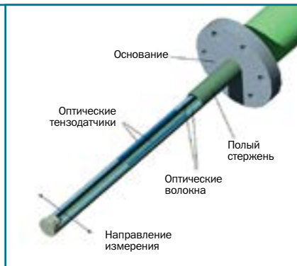
Рис. 2. Схема датчика силы сопротивления потока для измерения в реальном времени сил потока в обрабатываемом материале
