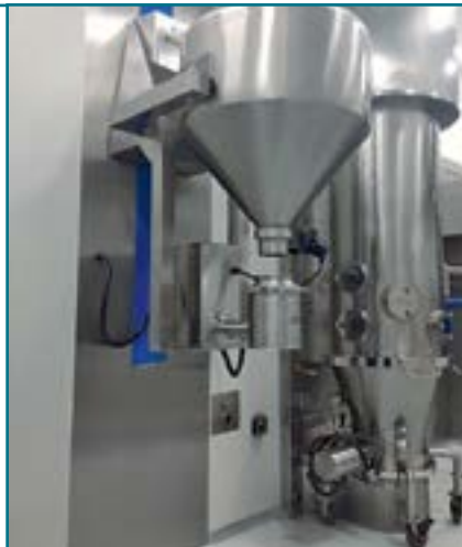
Рис. 2, 3. Многофункциональная установка псевдооживленного слоя и машина для сухого гранулирования
