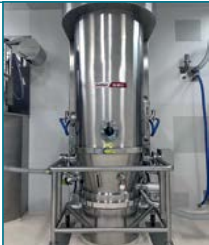
Рис. 2, 3. Многофункциональная установка псевдооживленного слоя и машина для сухого гранулирования
