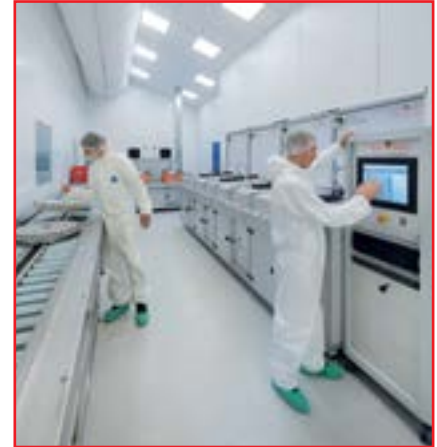
Плазменная обработка поверхности улучшает поверхностные свойства емкости MDI, что обеспечивает стабильность лекарственных препаратов.
