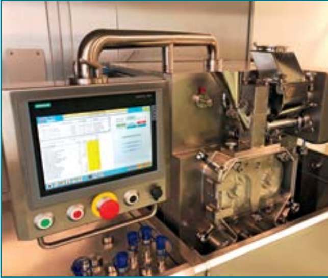
Роликовый пресс компании FAYTEC, интегрированный в барьерную систему на производственном участке компании Idorsia в г. Альшвилль (Actelion). Дисплей на поворотной опоре позволяет установить панель управления в контейнере с левой или с правой стороны
