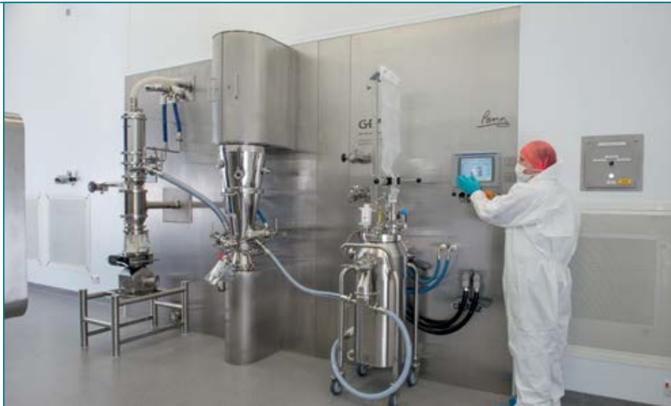
Оборудование GEA для влажной грануляции, установленное на предприятии Penn Pharma (Великобритания)
