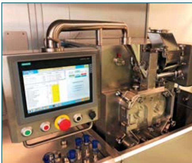
Роликовый пресс компании FAYTEC, интегрированный в барьерную систему на производственном участке компании Idorsia в г. Альшвиль (Actelion). Дисплей на поворотной опоре позволяет установить панель управления в контейнере с левой или с правой стороны
