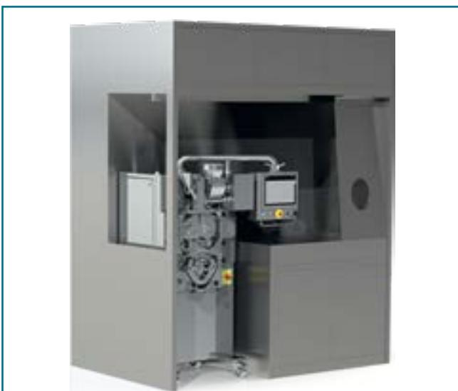
Проектный эскиз в формате 3D CAD, на котором представлена интеграция компактного гранулятора компании FAYTEC в барьерную систему
