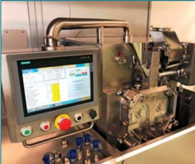
Роликовый пресс компании FAYTEC, интегрированный в барьерную систему на производственном участке компании Idorsia в г. Альшвилль (Actelion). Дисплей на поворотной опоре позволяет установить панель управления в контейнере с левой или с правой стороны
