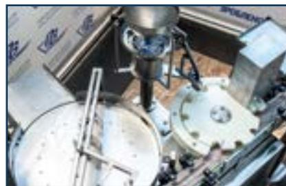
Рис. 2.2. Ориентатор с дополнительными бункером и инвертором
