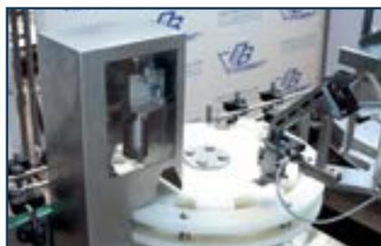
Рис. 2.1. Узел подачи колпачка и обжимки
