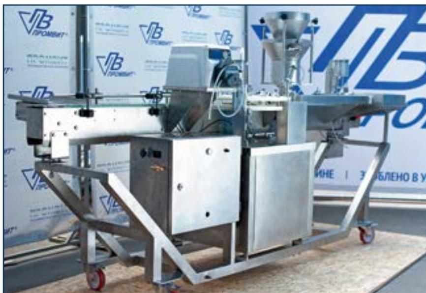
Рис. 1. Машина розлива и предварительной укупорки лиофильных флаконов. Размер машины: 2580 (L) x 760 (W) x 1340 (H)
