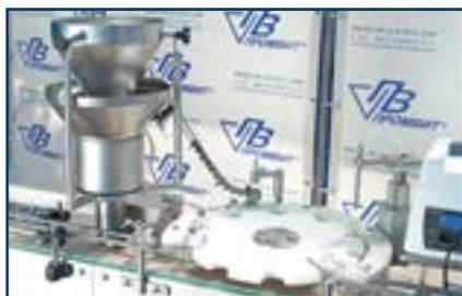
Рис. 1.1. Узел предварительной укупорки флакона
