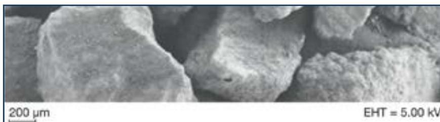
Рис. 1. Изображение РЭМ Ибупрофена DC 85 W (вторичная электронная эмиссия, 5 кВ, 12 нмРт)
