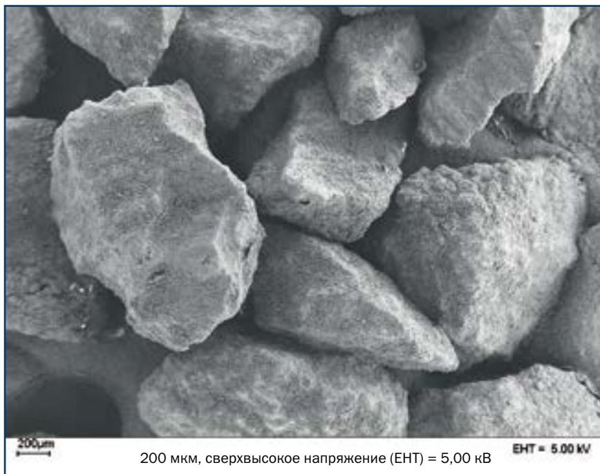
Рис. 1. Микрофотография смеси Ibuprofen DC 85 W, полученная с помощью метода сканирующей электронной микроскопии (детектор вторичных электронов (SE), 5 кВ, 12 нмPt)
