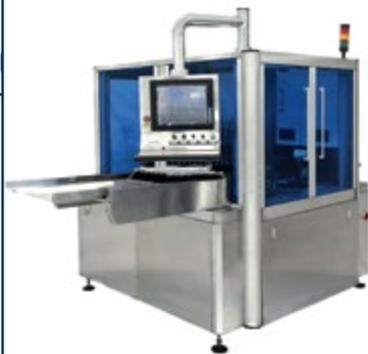
Автоматическая инспекционная машина для контроля примесей в ампульных растворах
