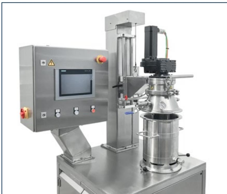
Вакуумная мешалка для приготовления гиалуроновой кислоты без включений воздуха
