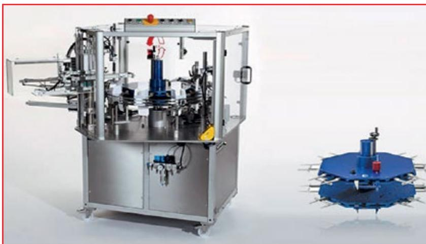
Модель NM702, которая может быть оснащена всеми специальными опциями и решениями, позволяющими качественно и эффективно производить такой продукт, имеет производительность до 80 туб в 1 мин. Эта машина – «бестселлер» компании NORDEN. Она разработана и изготовлена для производства продукции с соблюдением максимально возможного стандарта качества упаковки и с наиболее высокой эффективностью.
