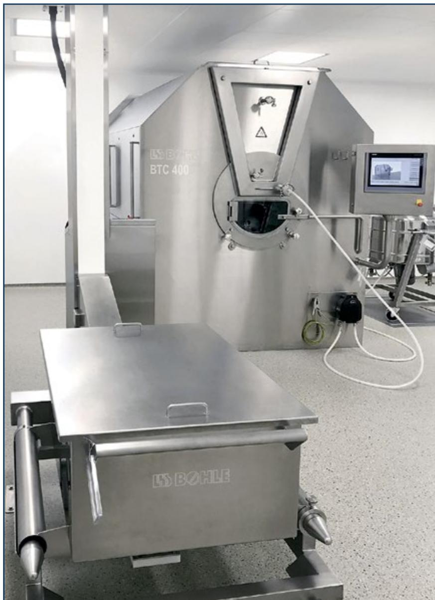
Рис. 1. Нанесение покрытия на таблетки с использованием высокоэффективной установки BTC 400 производства L.V. Böhle, которая позволяет на 35 % сократить время технологической обработки фармацевтических и нутрицевтических продуктов по сравнению с таковым при использовании аналогичного оборудования, а также обеспечивает значительное снижение затрат и более эффективную и длительную эксплуатацию
