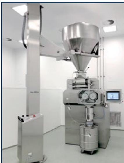
Рис. 3. BRC 100 в комбинации с подъемной колонной HS 1000. В ответ на ужесточающиеся требования, предъявляемые к процессам сухой грануляции, компания L.V. Bohle предлагает серию инновационных сухих грануляторов BRC с регулируемым зазором между валками. Оборудование серии BRC обеспечивает высокую производительность с минимальными потерями материала. Это достигается благодаря быстрому и точному контролю усилия компактирования и электромеханическому приводу обоих валков
