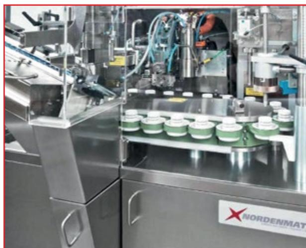
Рабочий стол машины, крышки и дверцы изготовлены из нержавеющей стали
