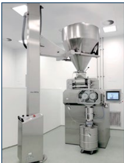
Рис. 3. BRC 100 в комбинации с подъемной колонной HS 1000. В ответ на ужесточающиеся требования, предъявляемые к процессам сухой грануляции, компания L.V. Bohle предлагает серию инновационных сухих грануляторов BRC с регулируемым зазором между валками. Оборудование серии BRC обеспечивает высокую производительность с минимальными потерями материала. Это достигается благодаря быстрому и точному контролю усилия компактирования и электромеханическому приводу обоих валков
