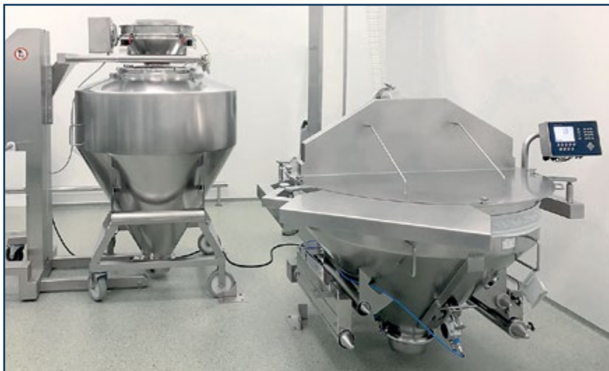
Рис. 2. Модульные системы для взвешивания и дозирования / распределения производства компании L.V. Bohle являются экономически выгодным решением для дозирования фармацевтических порошков. Для работы с активными фармацевтическими ингредиентами или сильнодействующими субстанциями, при производстве которых должны соблюдаться специальные требования, предъявляемые к безопасности и условиям окружающей среды, предлагаются встраиваемые изоляторы и ламинарные боксы
