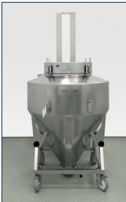
Рис. 4. Смеситель PM 1000 для фармацевтических продуктов – система производства компании L.V. Bohle для однородного смешивания партий сухих порошков благодаря запатентованному смешивающим элементам, встроенным внутри в крышки смесителя. Контейнеры смесителя взаимозаменяемы для оптимальной универсальности и, при необходимости, работы с различными объемами
