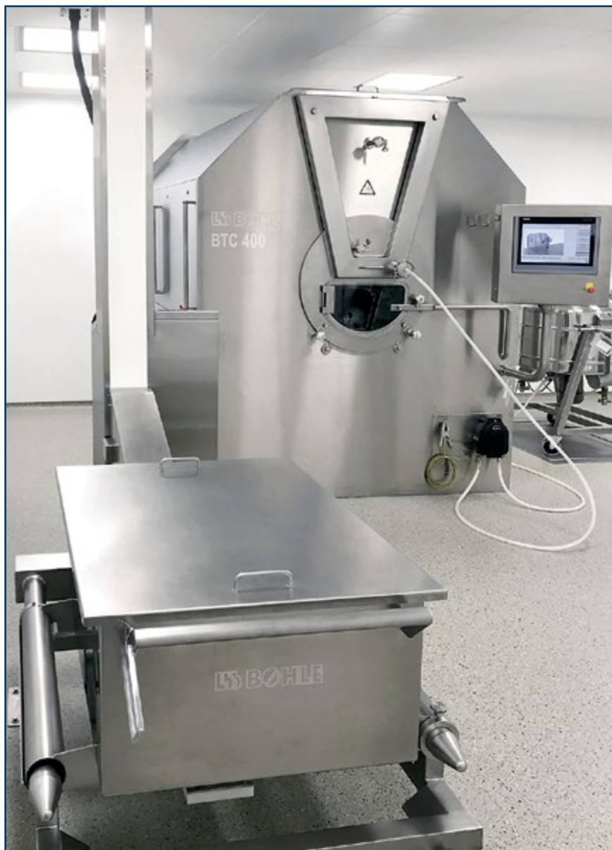
Рис. 1. Нанесение покрытия на таблетки с использованием высокоэффективной установки BTC 400 производства L.V. Böhle, которая позволяет на 35 % сократить время технологической обработки фармацевтических и нутрицевтических продуктов по сравнению с таковым при использовании аналогичного оборудования, а также обеспечивает значительное снижение затрат и более эффективную и длительную эксплуатацию
