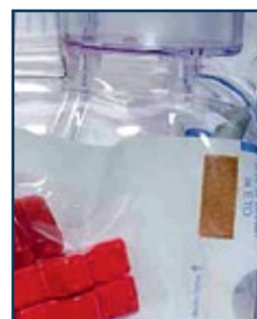
Рис. 7. Химический индикатор стерильности для длительного хранения, который имеется в каждой упаковке Stericheck, свидетельствует о том, что устройство прошло стерилизацию EO
