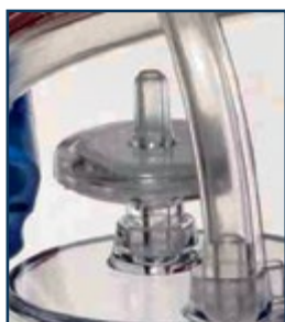
Рис. 4. Поднятое прозрачное вентиляционное отверстие сводит к минимуму риск попадания жидкости и дальнейшее препятствование потоку воздуха, а также обеспечивает легкую визуализацию в случае попадания жидкости
