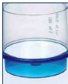
Рис. 6. Жесткая мембрана, выдерживающая случайное обратное давление. Имеется три разных типа мембран
