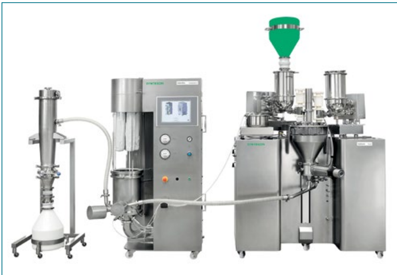
Xelum R&D непрерывно производит гранулят, который с помощью пневматической системы транспортируется в машину GKF 720 для наполнения капсул
