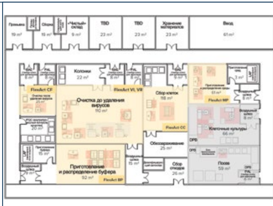
Рис. 5. Пример технологической схемы, демонстрирующий возможную область применения модуля FlexAct в рамках производственного процесса, полностью соответствующего cGMP
