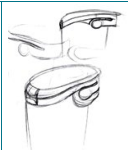
Рис. 1. Первые эскизы и рисунки в программе CAD упаковочного решения с защитой от вскрытия детьми
