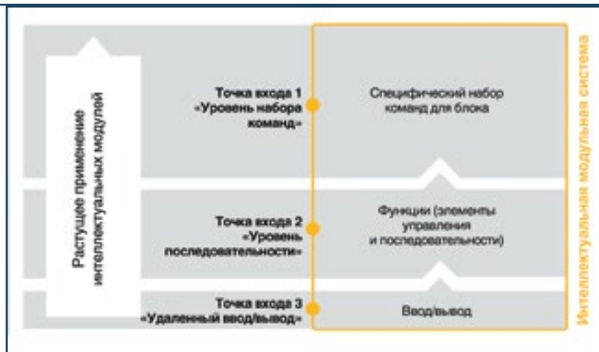
Рис. 2. Обзор точек входа для интеграции одноразовых интеллектуальных модульных систем в уровень управления технологическими процессами
