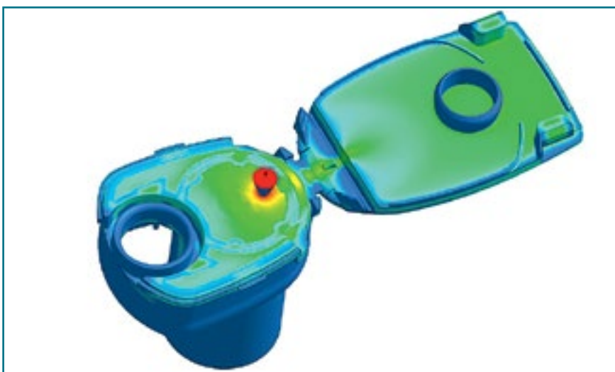
Рис. 2. Анализ заполнения материалом формы, близкой к промышленному образцу
