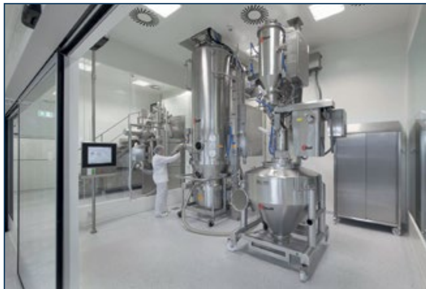
Линия производства сериями с системой вакуумной транспортировки, подъемной колонной, опорожняющей станцией и контейнером
