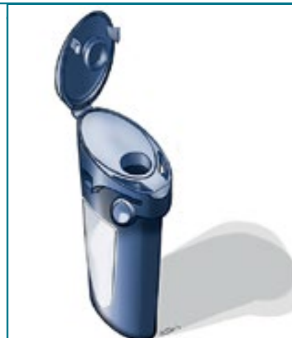
Рис. 1. Первые эскизы и рисунки в программе CAD упаковочного решения с защитой от вскрытия детьми
