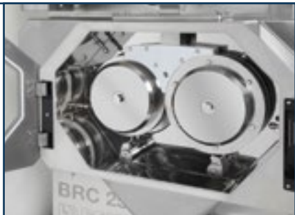
Рис. 2. В сочетании с чувствительной регулировкой зазора с помощью шнековой системы подачи обеспечиваются постоянные свойства полосок гранулята для всего диапазона производительности – от <1 до 400 кг/ч
