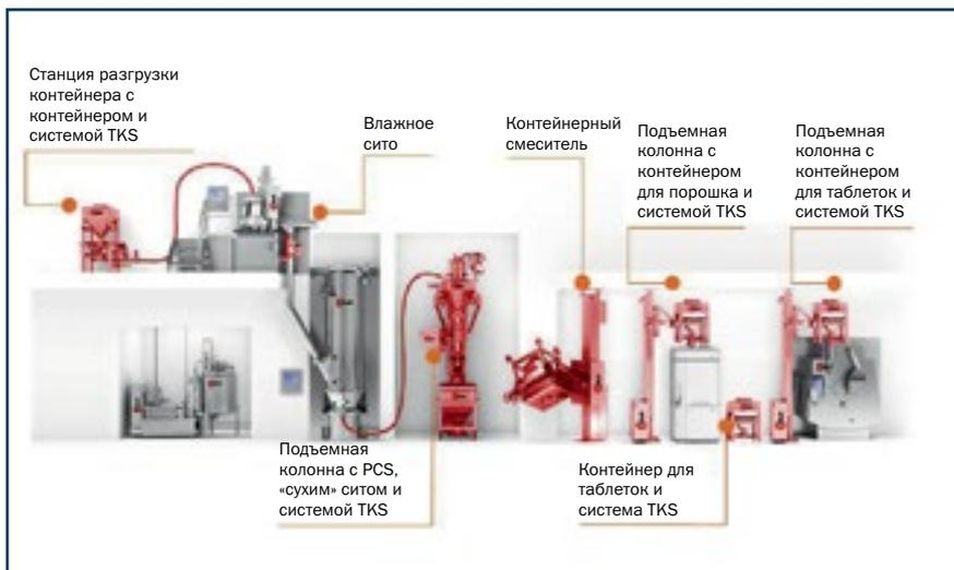
Погрузочно-разгрузочное оборудование с горизонтальным потоком продукта
