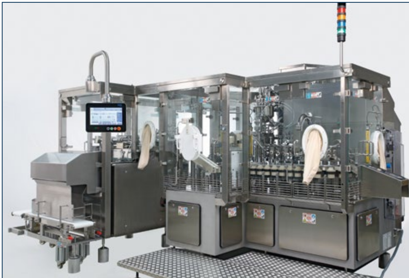
Стерильная тубонаполнительная линия TZ 101-FP 34-1, Класс 1 ИСО (AAA), Испания
