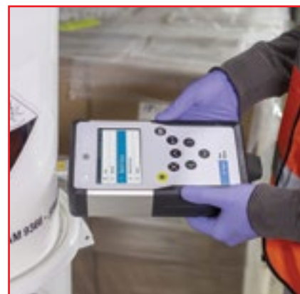
Рис. 3. Идентификация на складе сквозь непрозрачную упаковку с помощью Agilent Vaya
