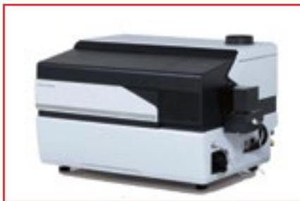
Фото № 4. ИСП-масс-спектрометр модели ICPMS-2030
