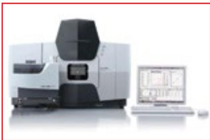
Фото № 1. Атомно-абсорбционный спектрофотометр модели AA-7000
