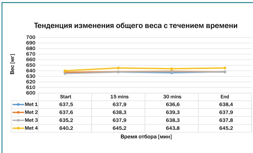
Рис. 1. Тенденция изменения общей массы с течением времени для всех партий, произведенных с помощью PREXIMA 300
