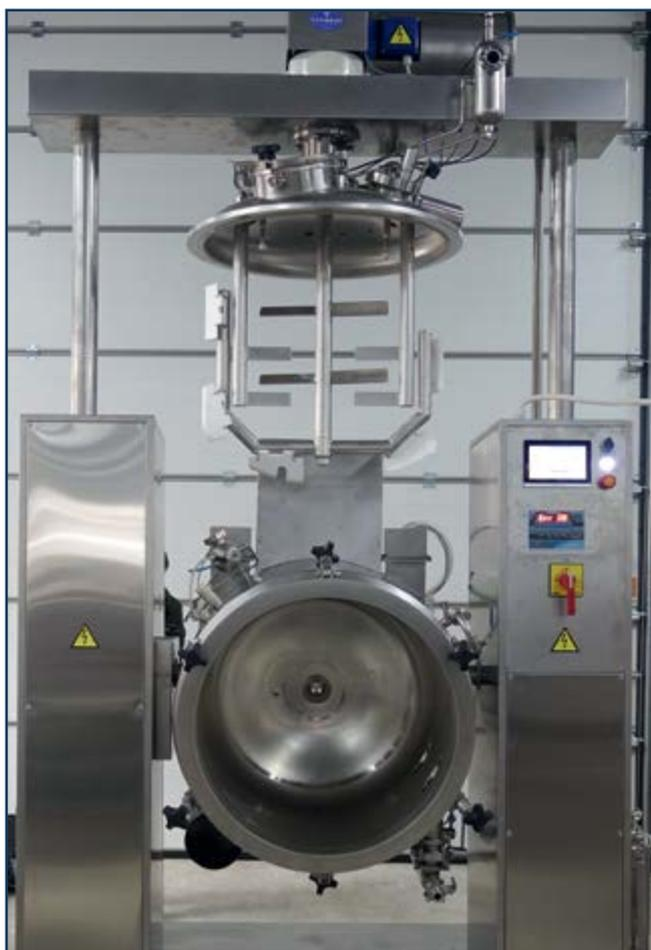
Реактор РСГПП-200 ВК в положении поднятой крышки и повернутым корпусом. Эти опции дают 100 % гарантии мойки корпуса и полную выгрузку готового продукта высокой вязкости
