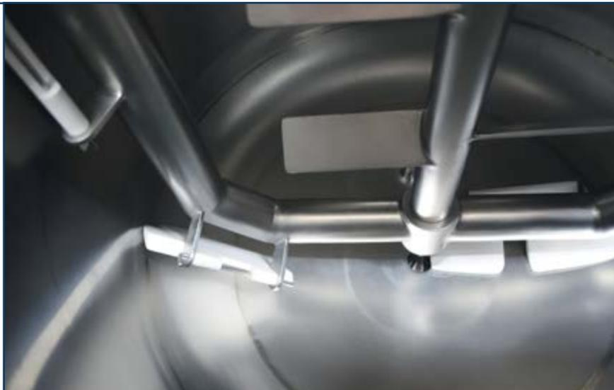
Корпус и мешалка плавителя с плавающими скребками из тефлона
