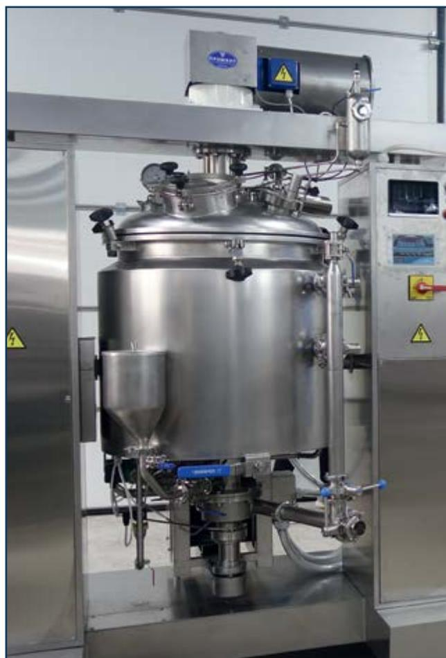
Реактор РСГПП-200 ВК – вакуумный реактор для вязких продуктов с механизмом подъема крышки, выносным гомогенизатором, внешним контуром циркуляции и механизмом поворота корпуса
