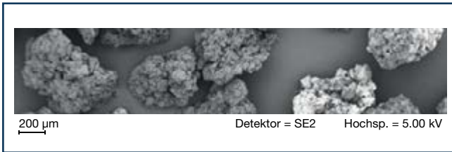
Рис. 6. РЭМ-изображение агломератов лактозы, полученных путем ГВУС с применением Kollidon® 25 в качестве связующего вещества
