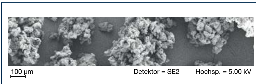
Рис. 9. РЭМ-изображение агломератов лактозы, полученных путем ГПС с применением Kollidon® 25 в качестве связующего вещества
