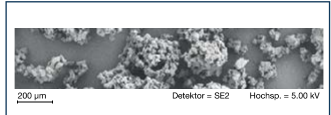
Рис. 11. РЭМ-изображение агломератов лактозы, полученных путем ГПС с применением Kollicoat® IR в качестве связующего вещества
