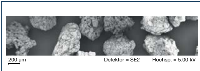
Рис. 7. РЭМ-изображение агломератов лактозы, полученных путем ГВУС с применением Kollidon® 90 F в качестве связующего вещества
