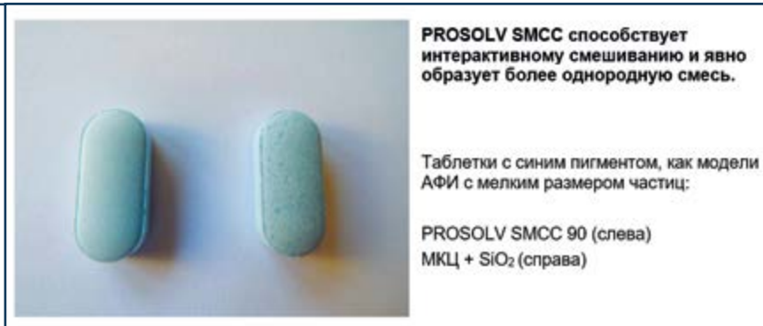
Рис. 4. Сравнение распределения синего пигмента при использовании PROSOLV SMCC и физической смеси
