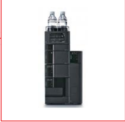
Фото № 1. Жидкостный хроматограф модели LC-40
