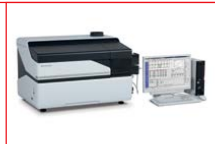
Фото № 6. ИСП-масс-спектрометр модели ICPMS-2030
