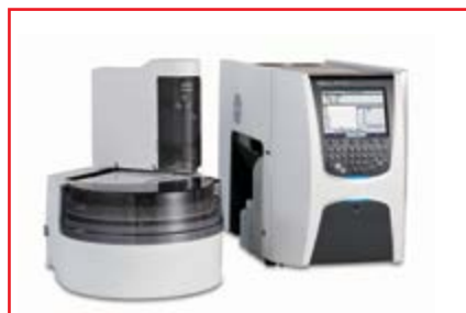
Фото № 7. ТОС-анализатор модели ТОС-L с автосамплером ASI-L
