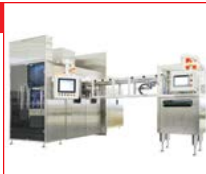
Линия формирования (выдува – наполнения-запайки (BFS)) пластиковых ампул и флаконов для инфузионных растворов
