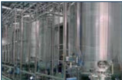
Система центрифугирования и глубокой фильтрации
