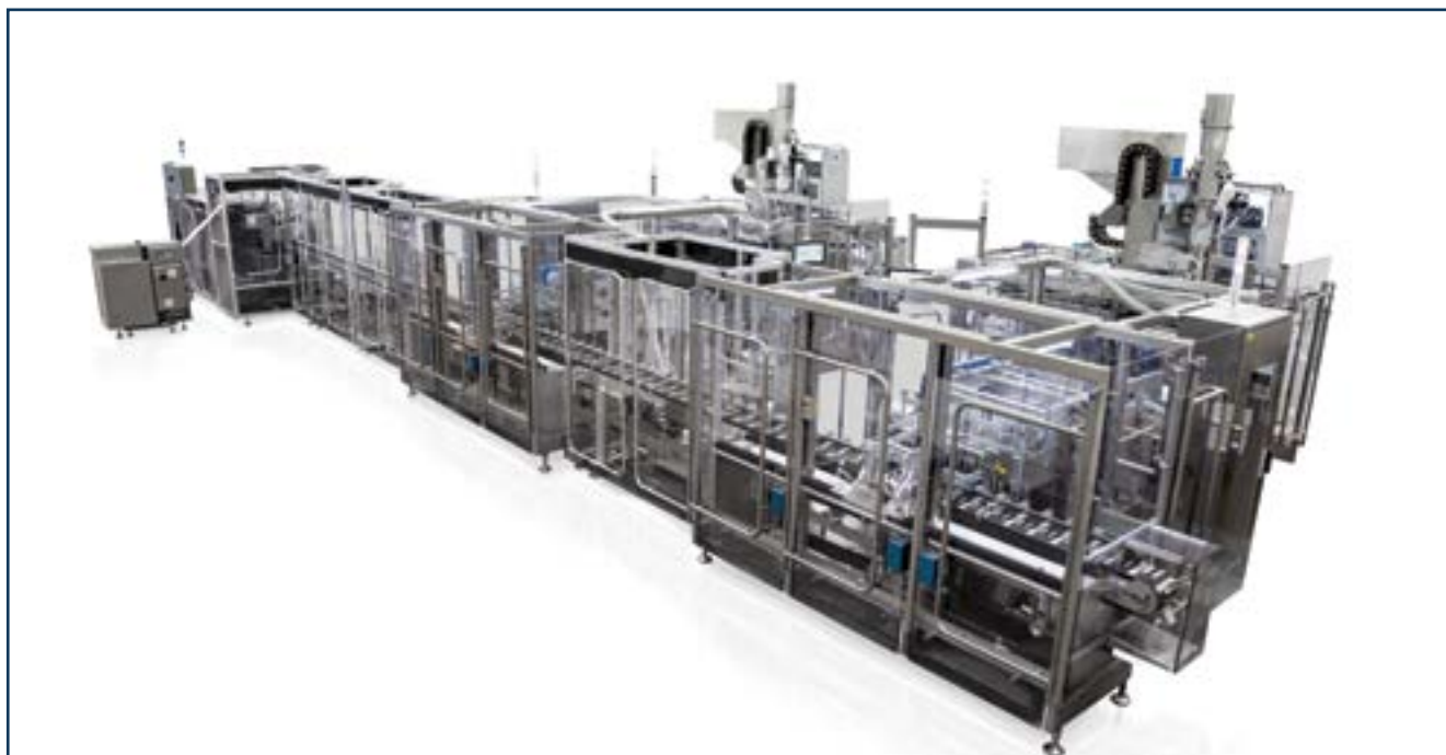
Модель Theta состоит из 2 Theta устройств, 2 счетных и штабелирующих устройств R80C, 2 синхронизирующих устройств непрерывного действия модели SC80 и картонной машины непрерывного действия
