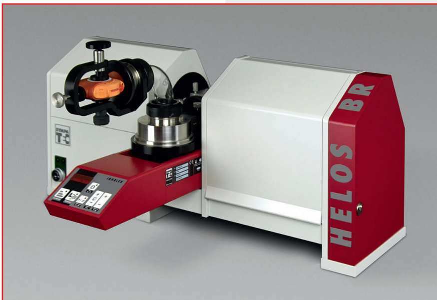
Рис. 1. Лазерный дифракционный гранулометр HELOS фирмы Sympatec GmbH с адаптивной системой INHALER (источник: Sympatec GmbH)
