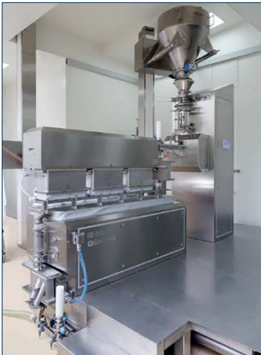
Важное событие в фармацевтическом производстве: установка QbCon® WG произвела революцию в технологии непрерывной влажной грануляции и сушки
