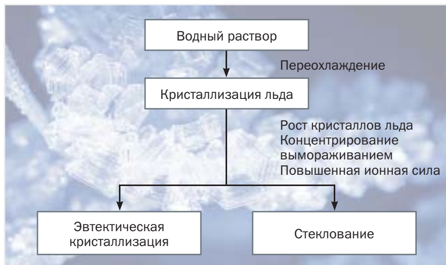
Рис. 3. Различное поведение водных растворов при заморозке
