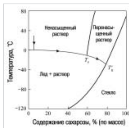
Рис. 6. Диаграмма твердое вещество – жидкость для системы сахара – вода
