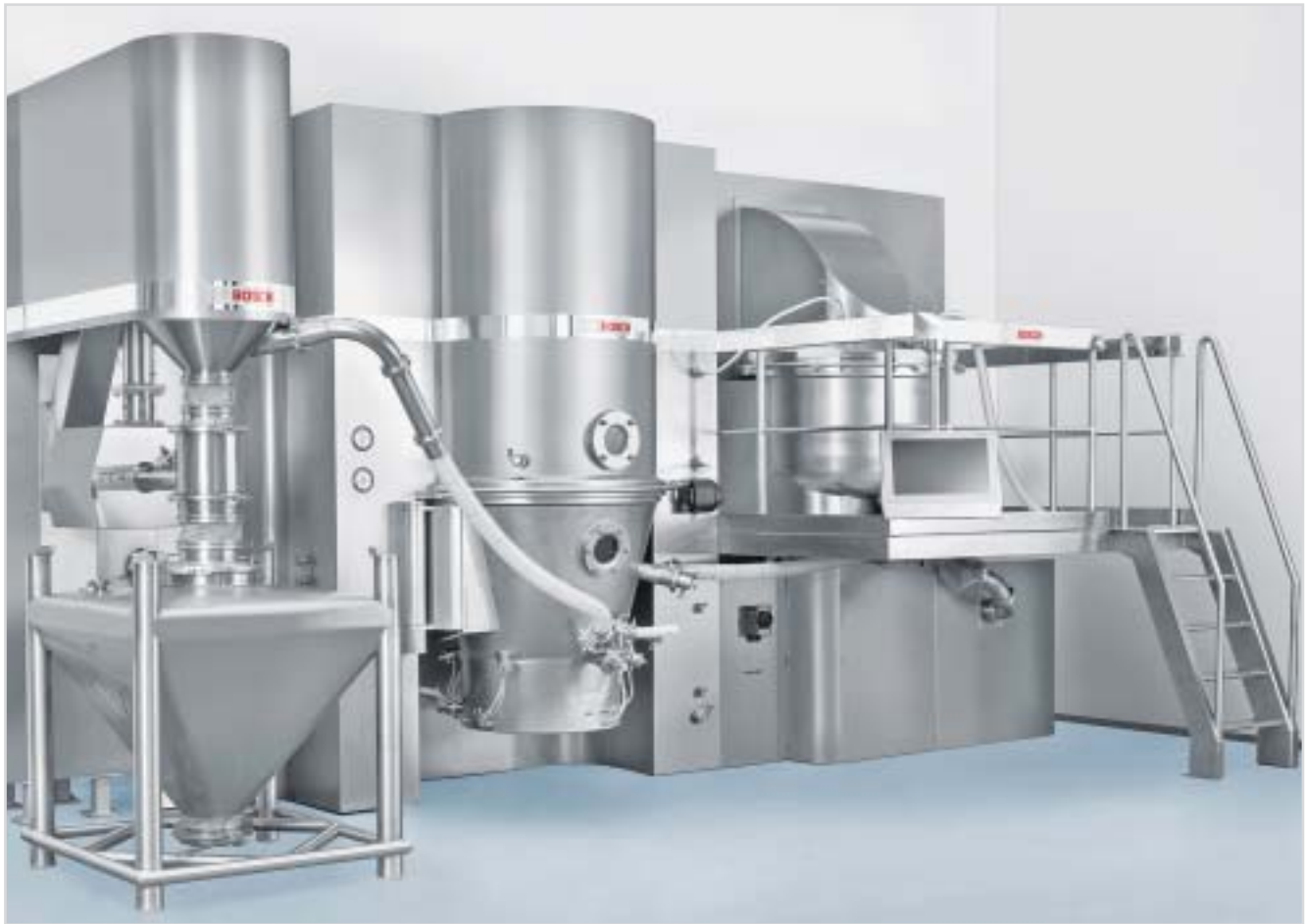
Новая линия грануляции Huttlin Granulean доступна в трех стандартных типоразмерах и включает в себя все технологические этапы – от смешивания и сушки до грануляции
