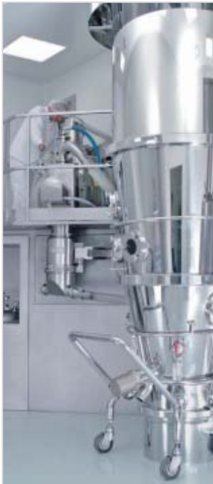
Рис. 5. Пример реализации технологической связки смесителя-гранулятора с высоким усилием сдвига и сушки в псевдооживленном слое (компания GEA Pharma Systems AG, Швейцария)
