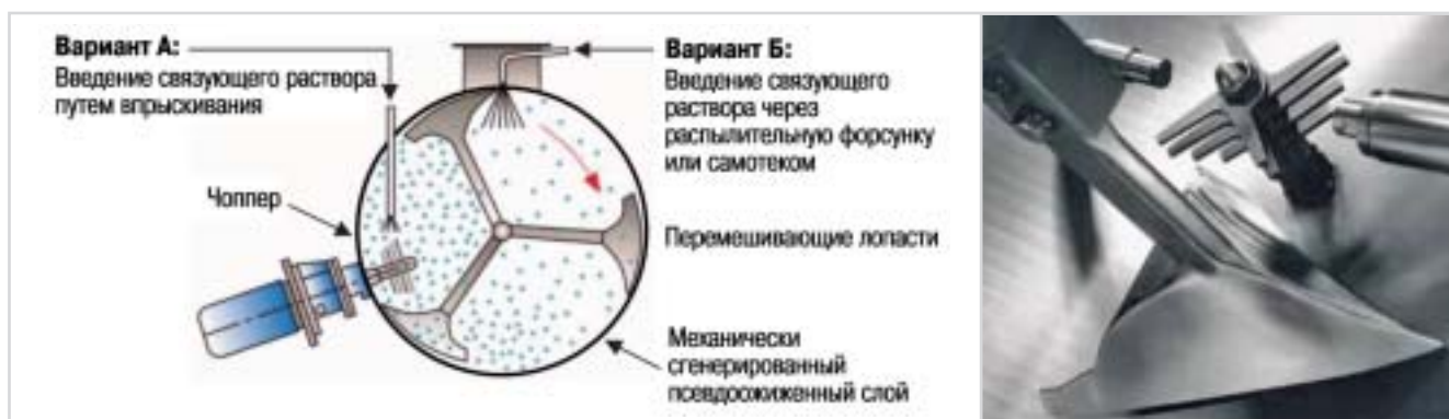
Рис. 1. Принципиальная схема рабочей части горизонтального смесителя-гранулятора с высоким усилием сдвига (слева) и фотография перемешивающей лопасти, чоппера и штуцера для подачи увлажнителя (справа) (Lödige, Германия)
