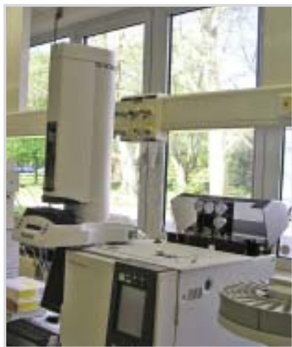
Фото № 6. Газовый хроматограф SHIMADZU модели GC-2014 с паровым автоинжектором HT-200H
