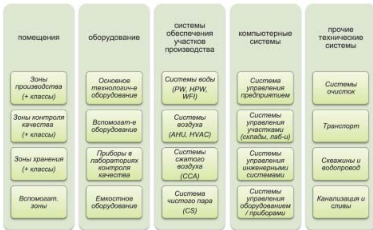
Рис. 4. Схема с перечнем групп основных объектов квалификационных испытаний
