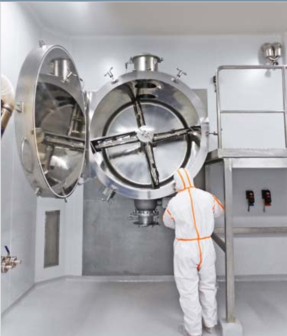
Установка сушилки CosmoDry® в чистой комнате
