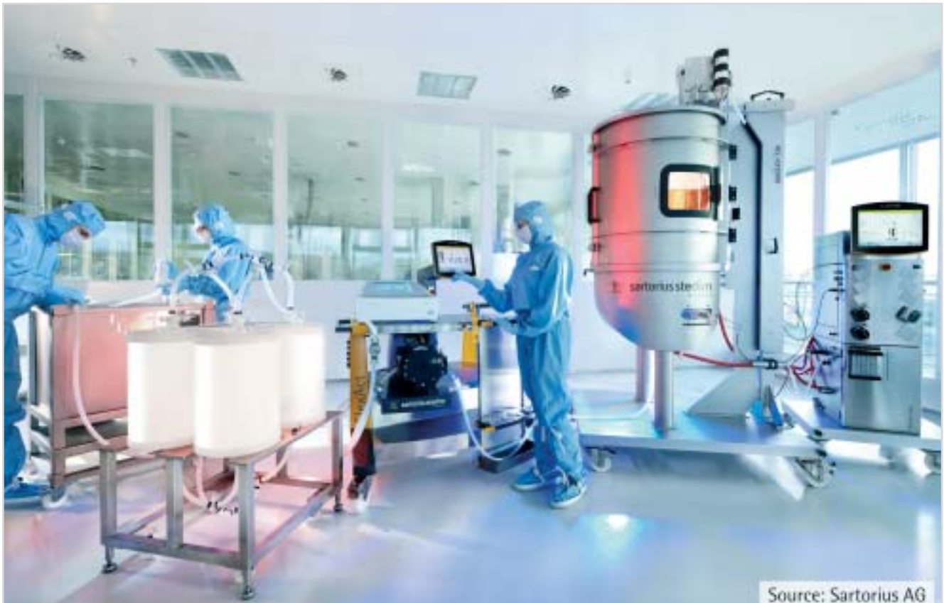
Рис. 2. Системы одноразового применения для первичной обработки производства компании Sartorius Stedim Biotech AG
