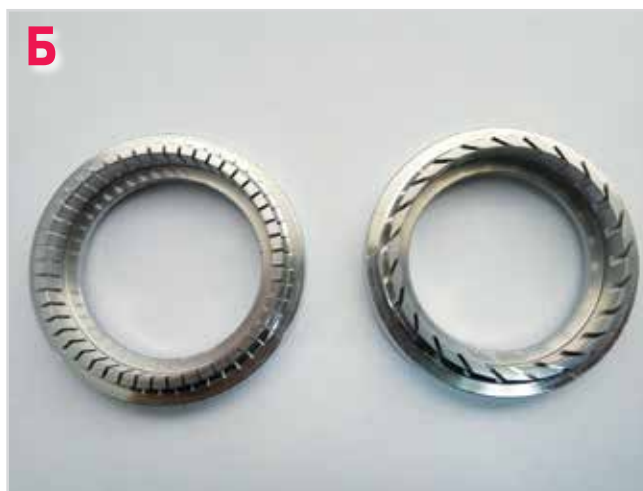
Рис. 1. Диспергатор типа «ротатор-статор» Megatron® MT 1-50 SHS F / 2 производства компании Kinematica AG (Швейцария) в комплекте с термостатом Julabo F-25, который выпускает компания Julabo Labortechnik GmbH (Германия) (А) и сменные статоры к диспергатору (Б)
