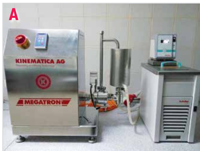
Рис. 1. Диспергатор типа «ротатор-статор» Megatron® MT 1-50 SHS F / 2 производства компании Kinematica AG (Швейцария) в комплекте с термостатом Julabo F-25, который выпускает компания Julabo Labortechnik GmbH (Германия) (А) и сменные статоры к диспергатору (Б)
