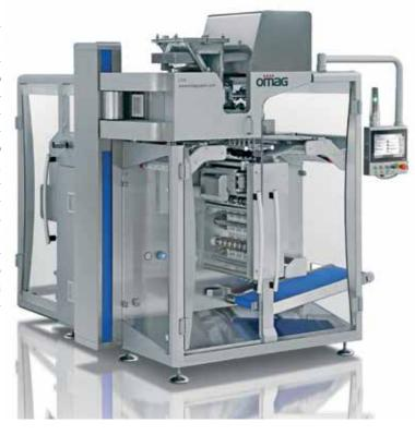
Вертикальный автомат модели СР для фасовки в 4-шовный пакет «фарм-саше» предназначен для фасовки таблеток, капсул и быстрорастворимых продуктов. Автомат также может быть укомплектован шнековым дозатором для порошкообразных и трудносыпучих продуктов, объемным дозатором для гранулированных и легкосыпучих продуктов, дозатором для жидких и кремообразных продуктов. ■
