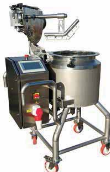
Реактор для жировой фазы с электроподогревом теплообменной рубашки и ассиметричной мешалкой, объем 70 л
