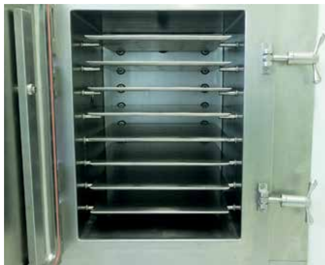
Специальная версия шкафа E0.2S для компании «Фармсинтез» (8 полок вместо 6 увеличивают площадь на 30 %)
