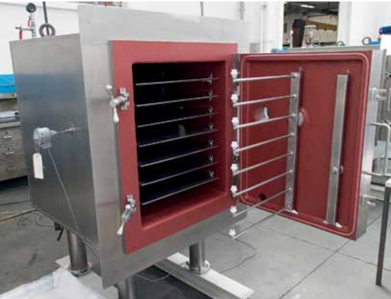
Шкаф E0.5S с полками из Hastelloy C22 и покрытием стен из PFA
