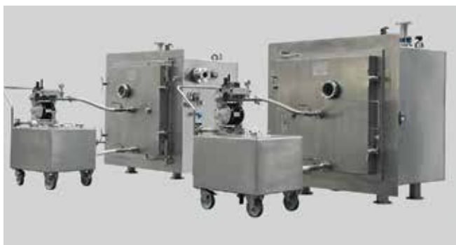
Сушильные шкафы MULTISPRAY с мобильными пневматическими мойками CIP
