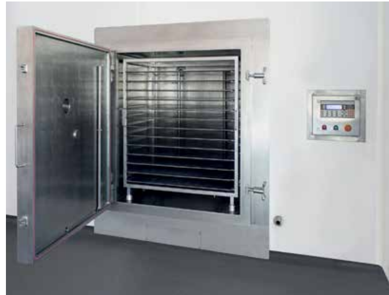
Сушильный шкаф E2.7PE с извлекаемыми полками на заводе Olainfarm в Латвии
