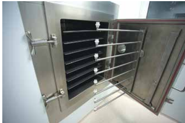
Сушильный шкаф E0.5S с распределителем CIP на заводе Cytomed в Санкт-Петербурге
