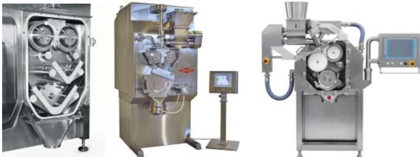
Рис. 2. Примеры роликовых компактеров различных производителей (слева направо): Pharmapaktor C 250 (Hosokawa), Chilsonator CCS 1025 (Fitzpatrick), Marco Pactor (Gerteis)
