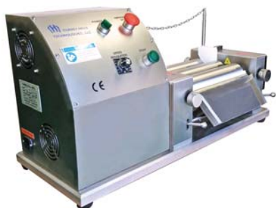
Рис. 4. Роликовая мельница T65B Ointment Mill (Torrey Hills Technologies, LLC, США)
