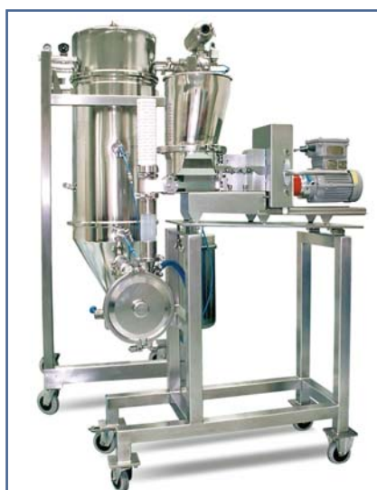
Рис. 6. Струйная мельница Alpine AS Spiral Jet Mill (HOSOKAWA ALPINE, Германия)
