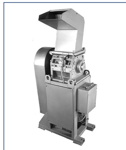
Рис. 13. Измельчитель «Корсар» Р-190 (ООО «Укр.Агро-сервис»)
