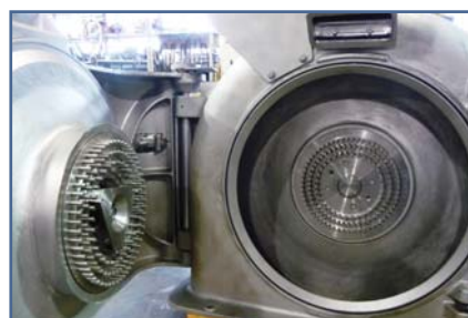
Рис. 7. Открытая рабочая камера дисмембратора Contraplex (HOSOKAWA ALPINE, Германия)
