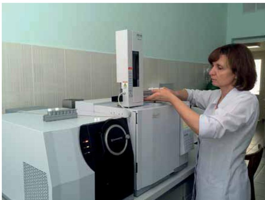
Фото № 1. Измерение на газовом хромато-масс-спектрометре модели GCMS-TQ8040 производства корпорации SHIMADZU
