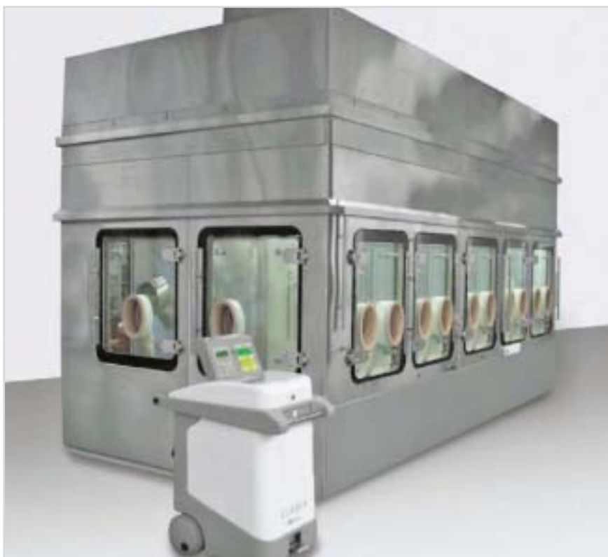
Фото 1.2. Закрытый RABS в линии производства глазных капель
