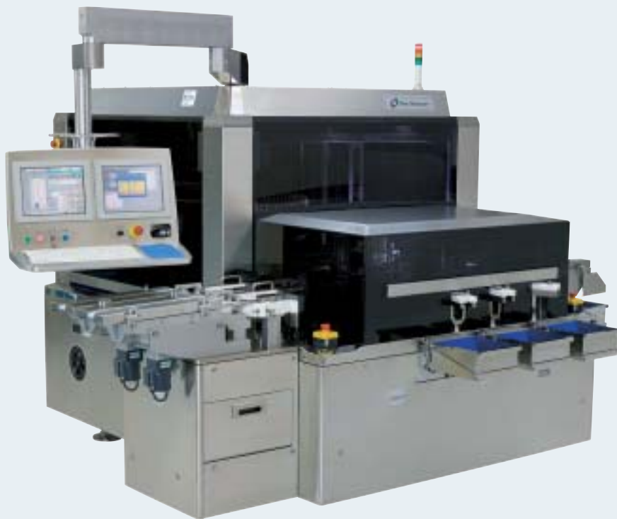
Рис. 1. EIS A206S для инспекции предварительно наполненных шприцев на наличие частиц и косметических дефектов
