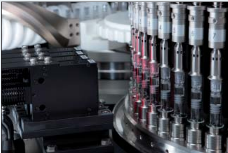
Рис. 2. Инспекция на наличие частиц с использованием технологии SD
