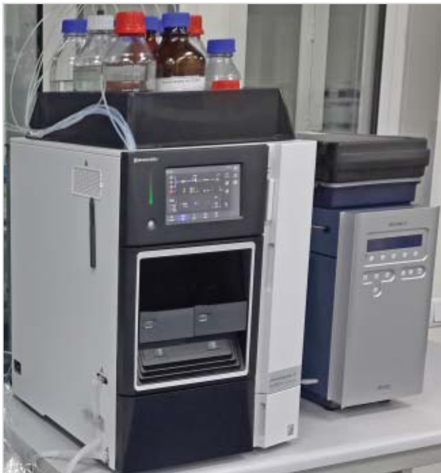
Фото № 3. Жидкостный хроматограф SHIMADZU модели LC-2030C-3D в сочетании с электрохимическим детектором DECADE II в лаборатории фармацевтического завода «Киевмедпрепарат»
