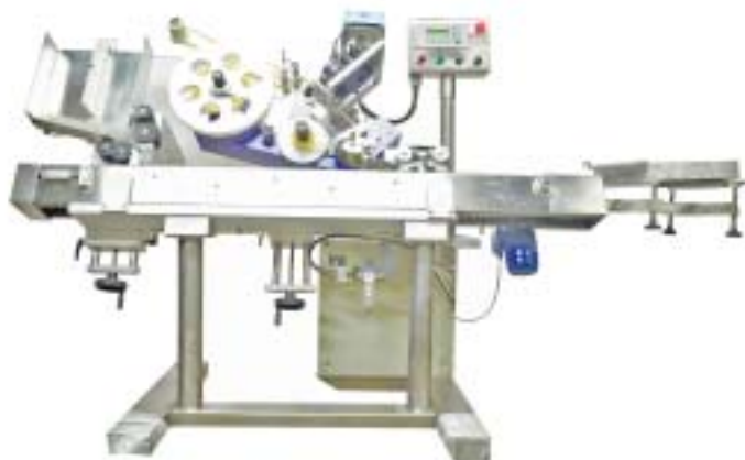
Рис. 3. Установка для нанесения самоклеющихся этикеток на ампулы / флаконы
