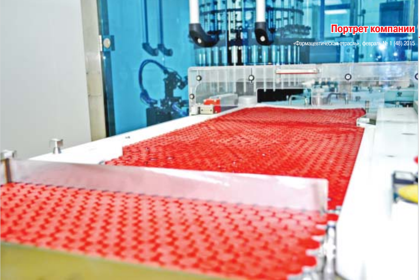
Машина для инспектирования флаконов, Brevetti S.E.A. (Италия)
