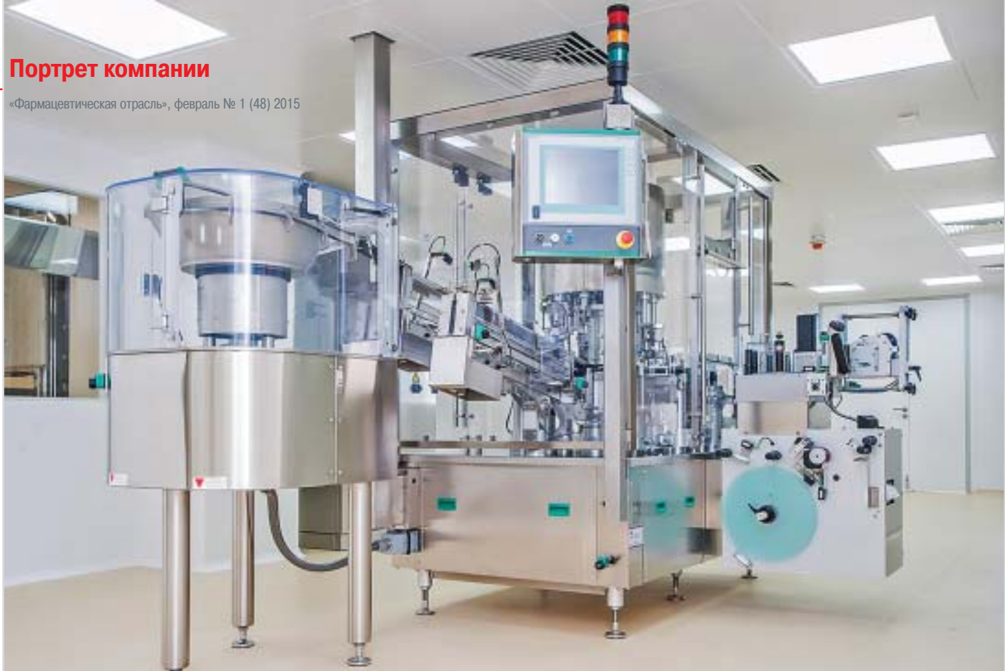
Машина для вставки штока и этикетирования преднаполненных шприцев, Marchesini GROUP S.p.A (Италия)
