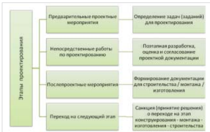
Рис. 1. Обобщенная схема последовательности основных стадий этапа проектирования производственного участка (зон, технических систем)
