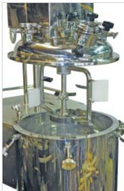
Рис. 2. Два типа мешалок в реакторе для приготовления раствора
