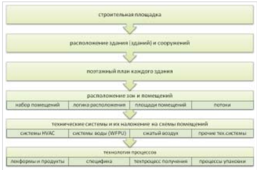
Рис. 2. Пример алгоритма последовательности планировочных, архитектурных и технологических решений при проектировании производственных участков
