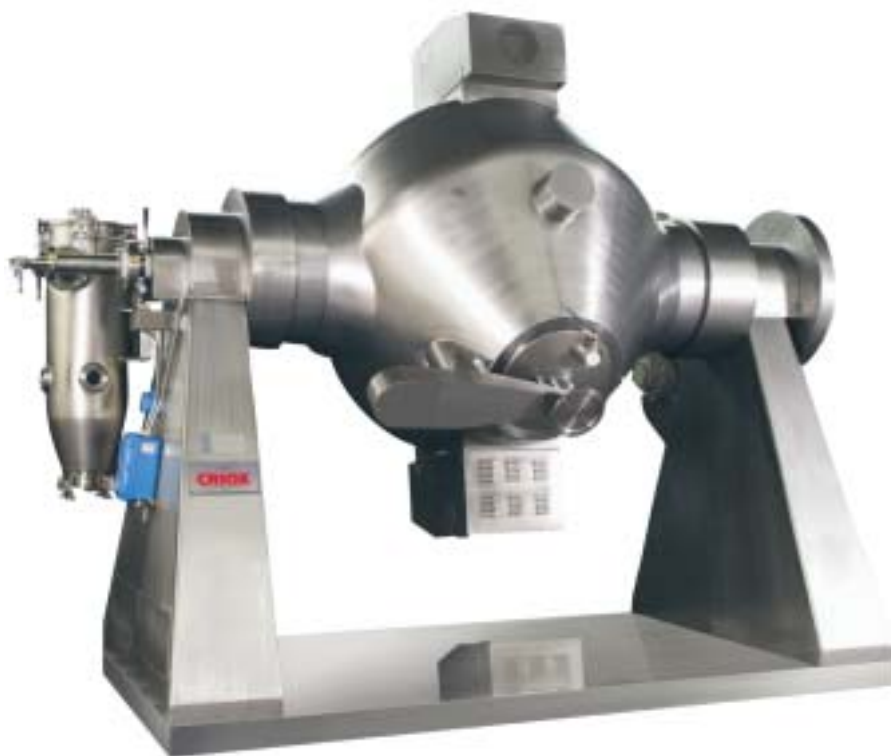
Сушильная система CRIOX в исполнении GMP для установки в чистом помещении
