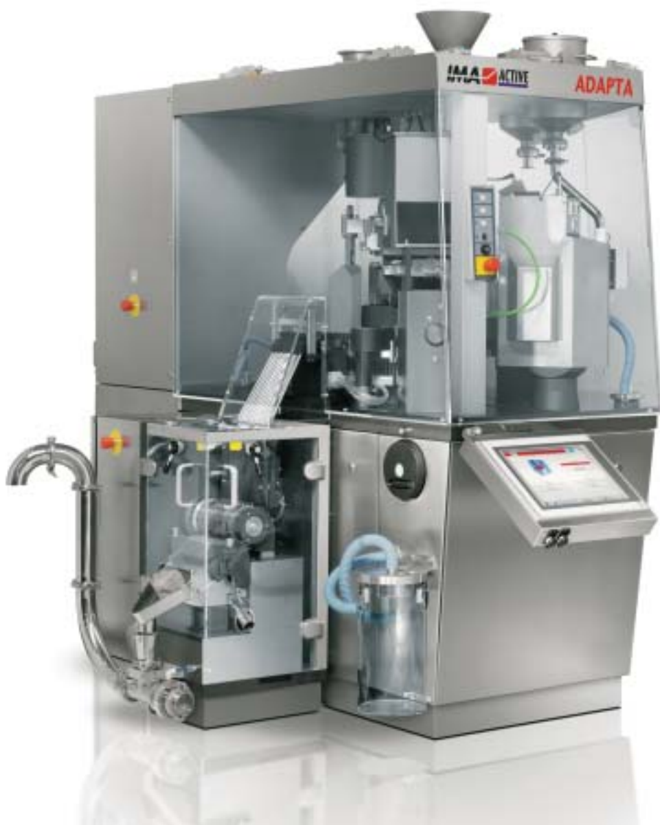
Рис. 1. Машина ADAPTA с системой полного контроля технологического процесса (TPC – Total Process Control), осуществляющая «онлайн» проверку веса всех 100 % капсул
