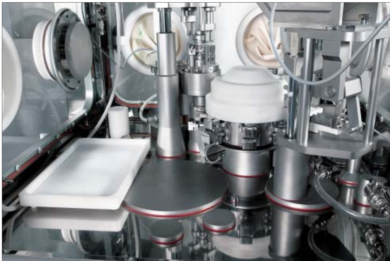
Рис. 2. Изолированная рабочая зона и порты доступа на машине для наполнения капсул Zanasi THC
