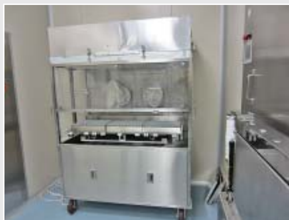
Полуавтоматическая загрузочная тележка с ламинарным потоком
