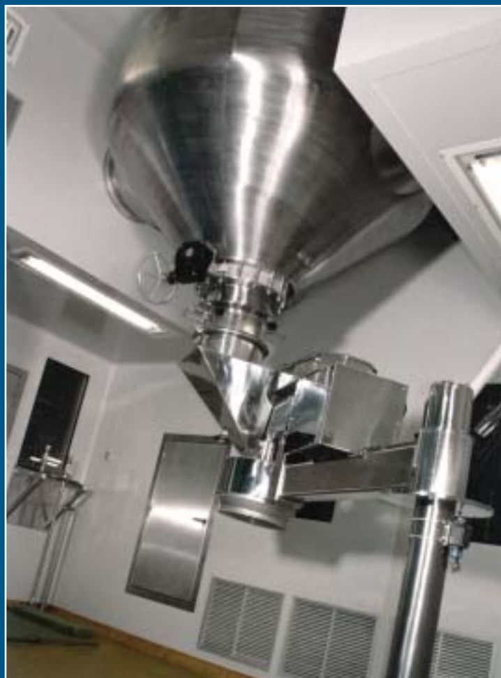
Раздельная установка CRIOX в чистой / технических зонах с модулем автоматической разгрузки
