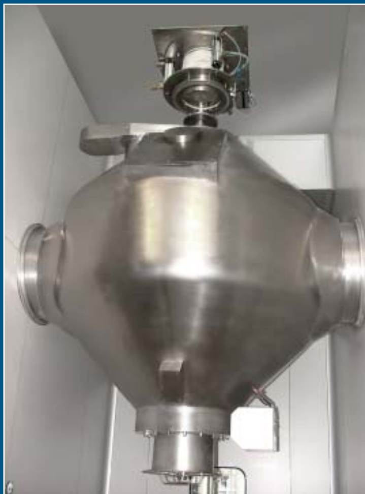
Сушилка CRIOX с раздельной установкой в чистой / технических зонах, а также с системой пневматической загрузки продукта
