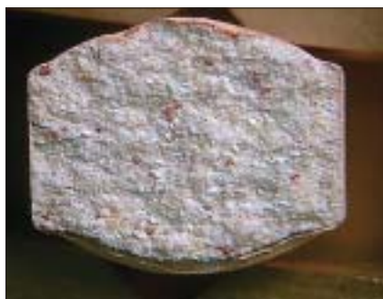
Рис. 6. Абразивные частицы в пищевой таблетке
