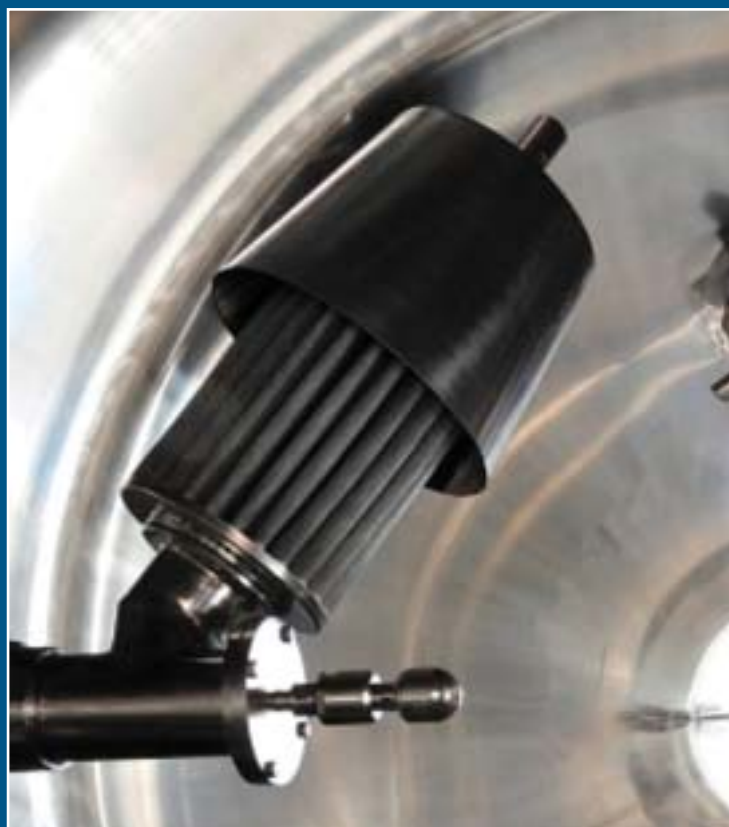
Внутренний картриджный фильтр с установленной на нем моющей CIP-головкой
