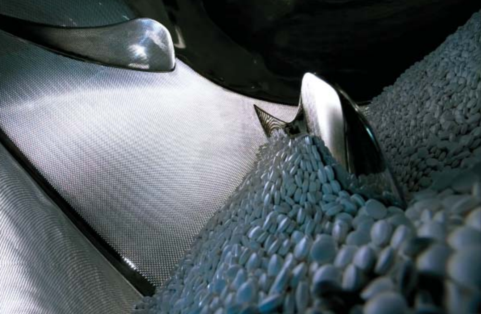
Внутренняя поверхность перфорированного барабана Perfima с таблетками
