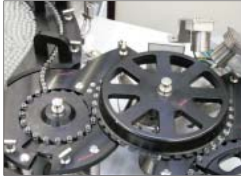
groninger UFV: транспортная и проверочная станция
