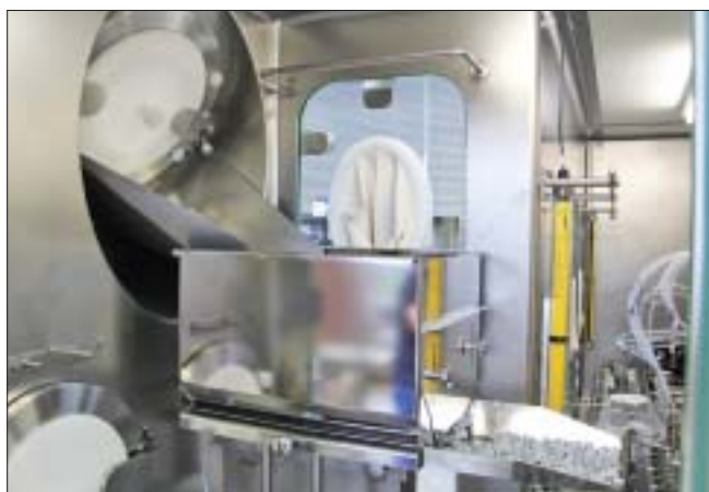
groninger UFVK 6005, подача стерильных пробок через RTP-порт (фотография сделана во время FAT-испытания на заводе groninger)
