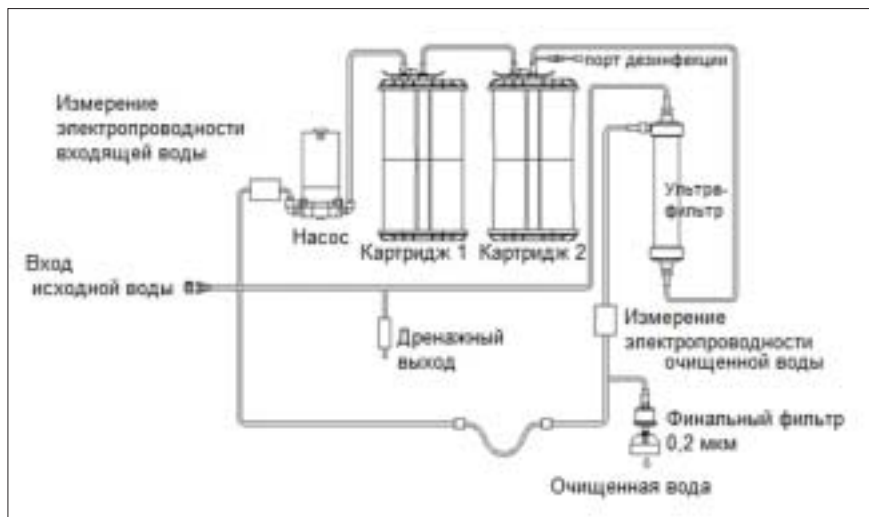
Рис. 2. Схема системы получения ультрачистой воды arium® pro UF
