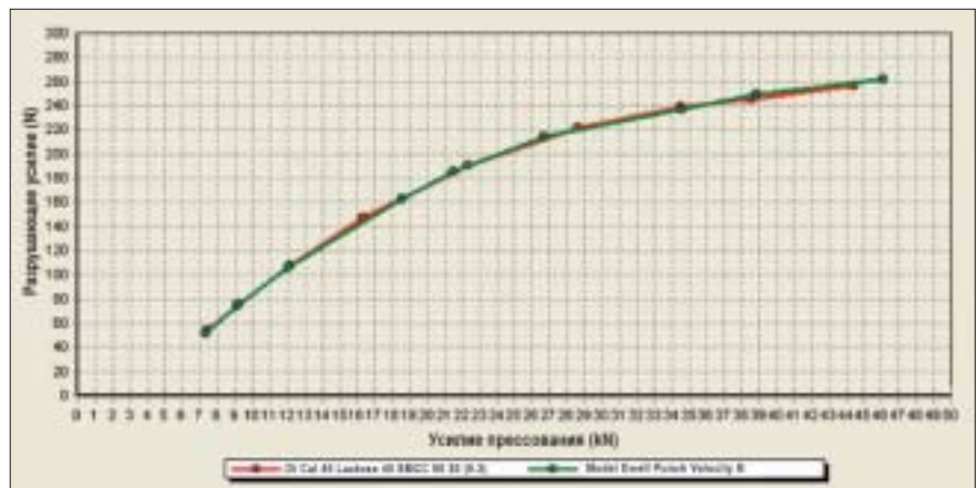
Рис. 9. Сравнение профилей прессования таблеток на 1-станционном таблетировочном прессе [1] и 19-станционном таблетировочном прессе [2] при идентичной скорости загрузки. Машина производит таблетки одинаковой твердости
