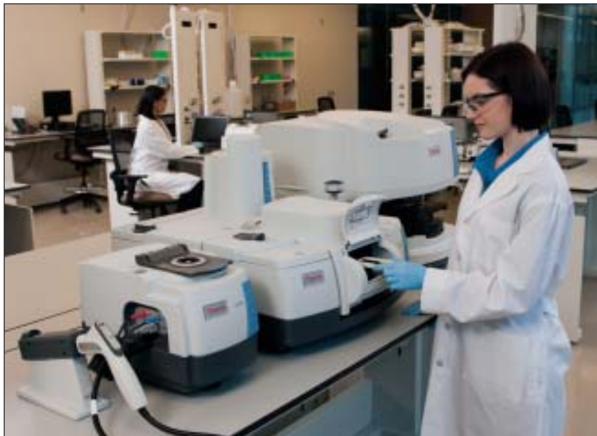
Рис. 3. ИК-Фурье спектрометр Nicolet iS50, оснащенный различными модулями
