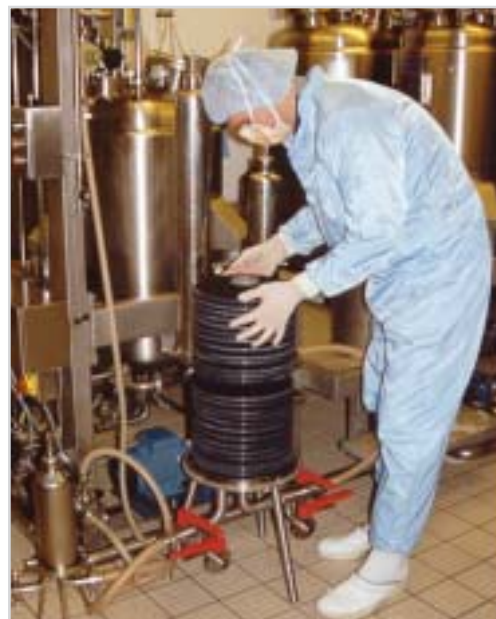
Рис. 2. Типичный процесс обесцвечивания на АУ активных фармацевтических полупродуктов
