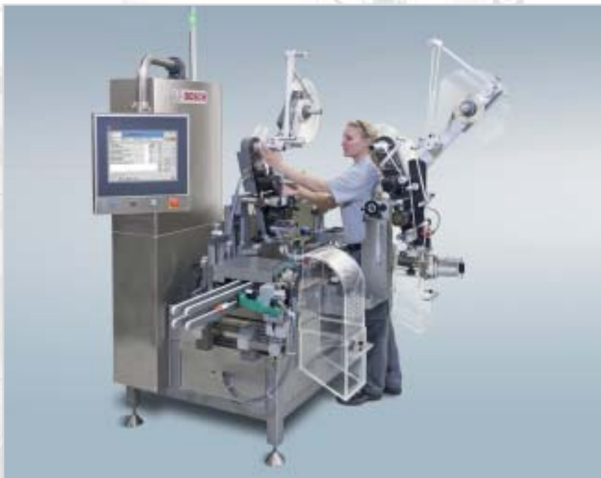
Модульная система нанесения маркировки на картонную упаковку (CPS) с контролем первого вскрытия соответствует требованиям к сериализации, отслеживаемости и идентификации
