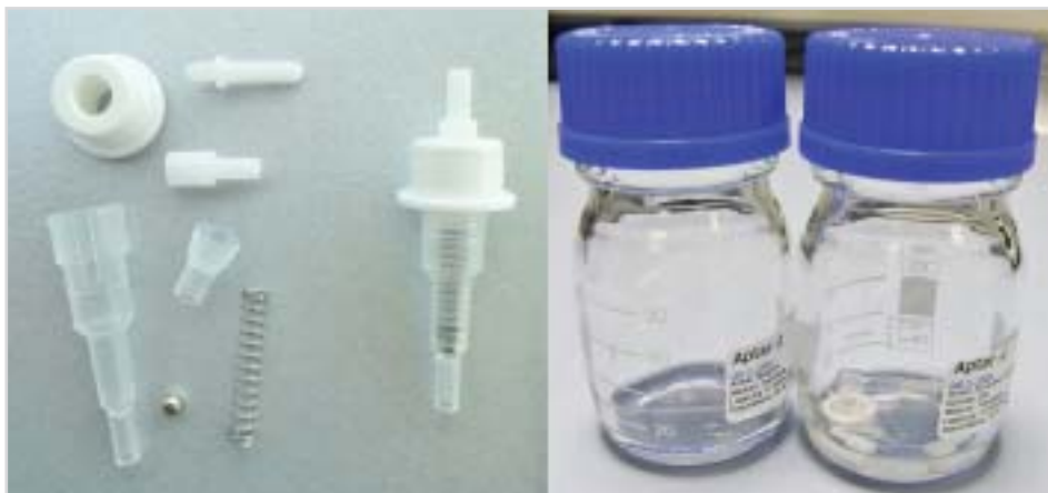
Рис. 1. Составные части стандартной помпы и помпа в собранном виде. В правой части рисунка: экспозиция деталей в растворе лекарственного средства для проверки совместимости. Для наглядности показаны составные части только одной помпы
