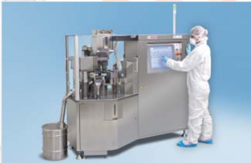
Аппарат ККХ 3900 производства компании Bosch одновременно контролирует несколько качественных параметров процесса, таких как масса, размер и положение заполненной капсулы
