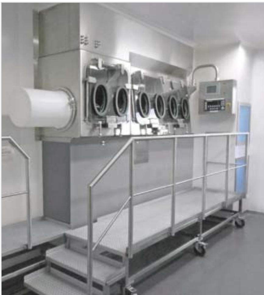
Фото 3. Передаточный изолятор ОЕВ 5
