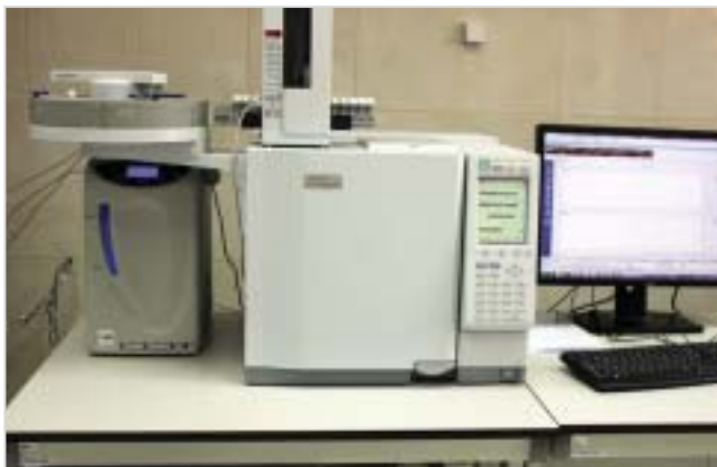
Фото № 2. Газовый хроматограф SHIMADZU модели GC-2010 Plus с автоинжектором AOC-20i и автосамплером AOC-20s
