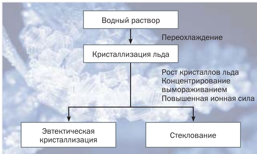
Рис. 3. Различное поведение водных растворов при заморозке
