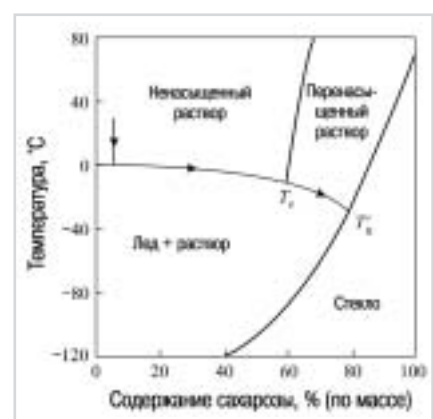
Рис. 6. Диаграмма твердое вещество – жидкость для системы сахара – вода
