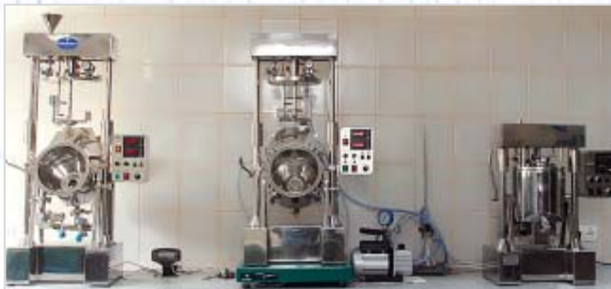
Рис. 3. Вакуумные реакторы-гомогенизаторы разных типов (слева направо): РР-5-ВК (с выносным гомогенизатором и внешним контуром циркуляции), РР-5Д и РР-5 (со встроенными гомогенизаторами)
