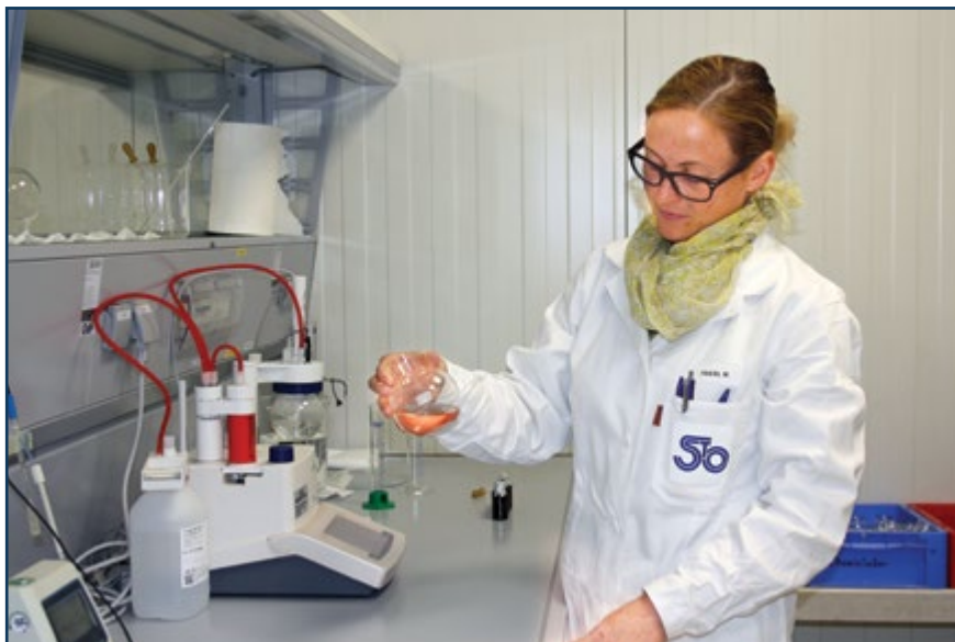
Испытание флаконов в титраторе
