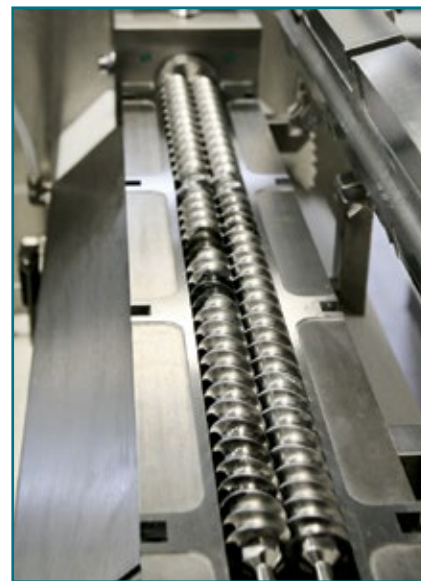
Рис. 2. Вид рабочей зоны гранулятора, который входит в состав установки QbCon® 1
