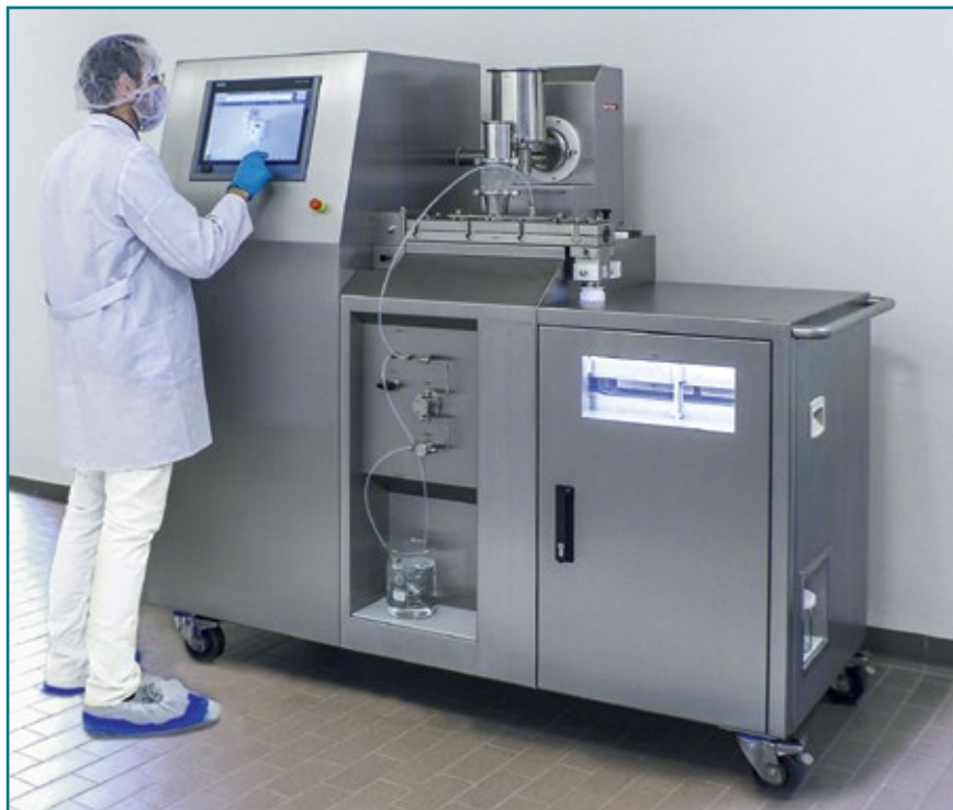
Рис. 1. QbCon® 1 – полностью интегрированная система непрерывного действия для производства гранул
